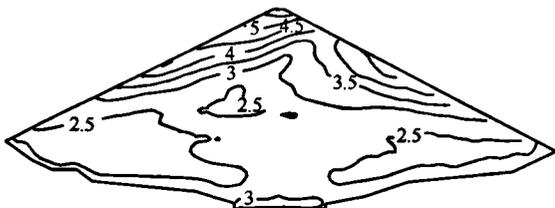
图 16 大坝最大断面顺河向加速度极值分布 (单位:  $m/s^2$ )
